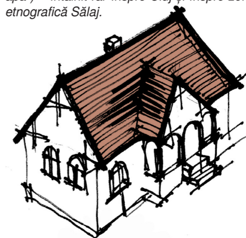
Casă din anii '50 cu friguria din zidărie amplasată, de obicei, paralel cu strada. Aceste case sunt mai late și au șarpante pe scaune.
