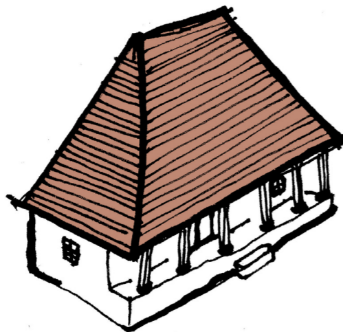
Casă la Pria unde panta acoperișului de țiglă solzi este a unui acoperiș din paie în patru ape; se remarcă șoșii ce sprijină pe lespezi de piatră pe vechea prispă.
